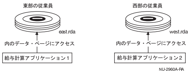
図 3-4 パーティション・アプリケーションのページ・ロックによる効果
