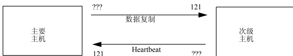
图 1-2 Remote Mirror 软件使用的 TCP/IP 端口地址
