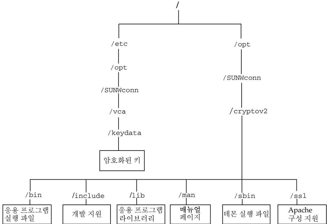
**그림 2-1** Sun Crypto Accelerator 4000 디렉토리 및 파일
