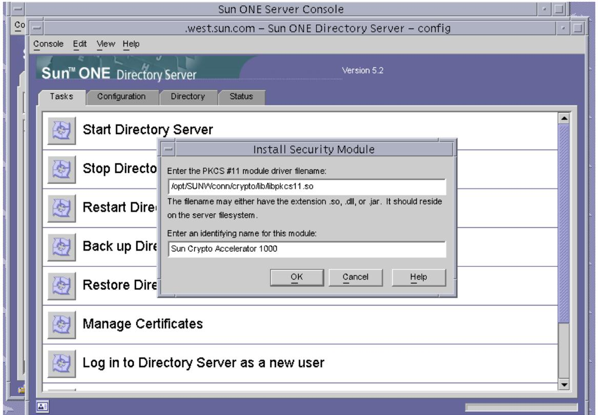
圖 5-10 Sun ONE Directory Server 的 Install Security Module (安裝安全模組) 對話方塊
