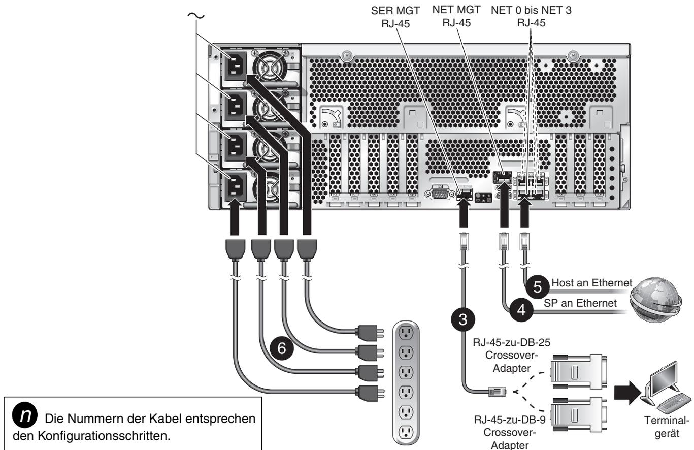
4. (Optional) Verbinden Sie den Netzwerkanschluss NET MGT des Servers (ABBILDUNG 2) über ein Ethernet-Kabel mit dem Netzwerk, über das in Zukunft Verbindungen zum Service-Prozessor und Host hergestellt werden sollen.
